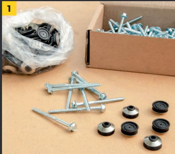
**1** Pour appliquer les vis, choisies en fonction du matériau de la structure, **la plaque doit être pré-percée avec une mèche de section supérieure de 3 mm par rapport à celle de la tige de la vis** ; ceci pour donner une tolérance à la dilatation de la plaque.
