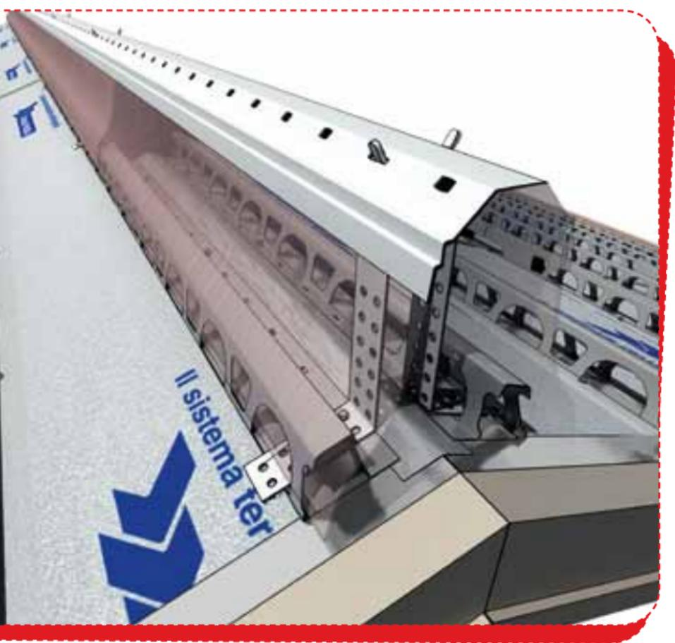
Poser le closoir en zinc-plomb et l'intégrant aux ailettes sur le haut des réhausses de faîtage. Ensuite l'ancrer en les repliant.
