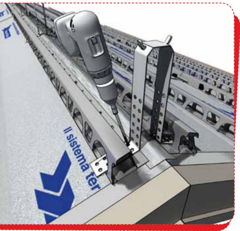
On positionne le linteau métallique en le fixant à la structure au-dessous à une distance opportune pour soutenir la dernière rangée de tuiles, on fixe les réhausses de faîtage à la partie plate du linteau (tous les 65 cm environ).
