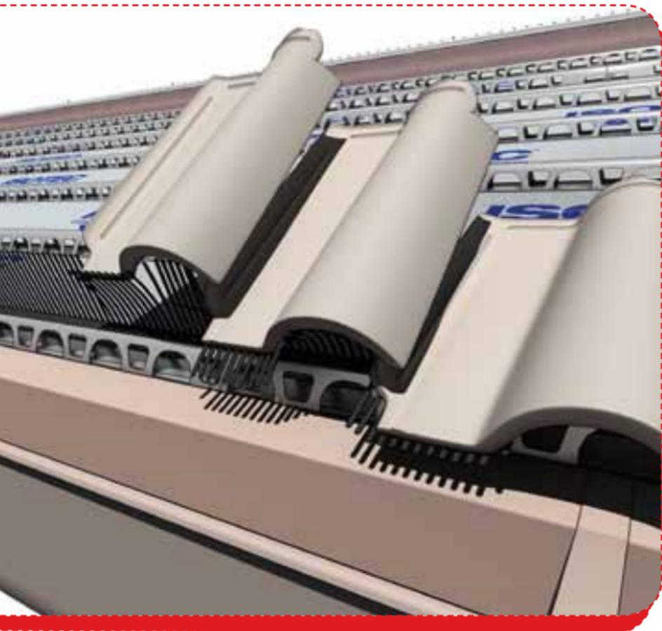
Le long de la ligne de gouttière, il est opportun d'utiliser le peigne pare-oiseaux. Son épaisseur assure la continuité de pente dans la pose de la première rangée de tuiles sur la gouttière (s'assurer que la pose soit faite dans le bon sens avec les peignes tournés vers l'extérieur). Pour la fixation, il est possible d'utiliser d'autres dispositifs d'ancrage suivant les dispositions des fabricants des couvertures, les normes techniques (ex. UNI 9460) ou aux usage de pose locaux.
