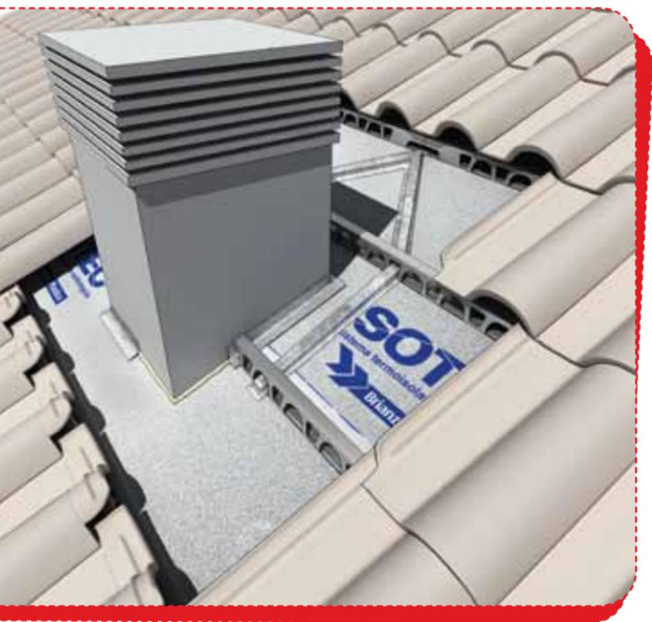
Tous les corps émergents de la couverture, tels que cheminées, conduits d'émanation, lucarnes, fenêtres de toit, etc., devront être raccordés au panneau Isotec en utilisant la mousse de polyuréthane imperméabilisée par la bande butyle et, ensuite, une protection en "V" renversé devra être positionnée en amont du corps émergents.
