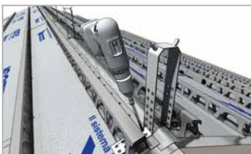
Après avoir atteint le faîtage, étancher avec la mousse de polyuréthane l'espace entre les panneaux au niveau du faîtage, l'excès de mousse et sceller en appliquant un ruban de butyle-aluminium. Placer le profil métallique et le fixer au cadre inférieur à une distance appropriée pour soutenir la dernière rangée de tuiles. Installer la plaque sous-faîtière, la plier et la fixer.
