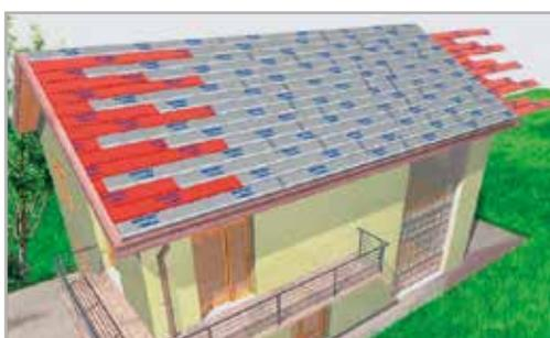
Poursuivre avec la deuxième rangée et les rangées suivantes, en découpant la longueur de panneaux de manière à être en quinconce avec les joints latéraux de la rangée précédente. Les parties découpées des panneaux sont utilisées pour les rangées suivantes, jusqu'à l'atteinte du faîtage du toit. **Cette technique de pose diminue le taux de chute à environ 3% du total.**
